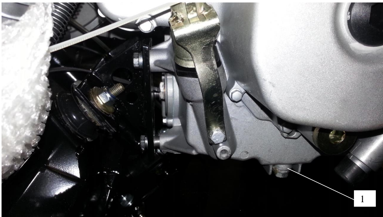
Рисунок 21 – Слив моторного масла
