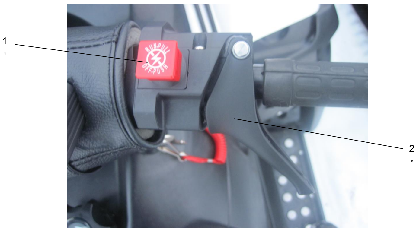
Рисунок 4в - Расположение органов управления на левом блоке руля снегохода TAYGA Patrol 800 SWT
