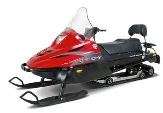
Основные отличия от модели «ВАРЯГ 550» в конструкции задней подвески: новая конструкция с горизонтальным расположением амортизатора позволила увеличить ход задней подвески с 19 до 38.5 см при сохранении энергоемкости. Ход передней подвески увеличен до 15 см. Комплектация расширена использованием гусеницы Magnum с грунтозацепом 3.2 см и наличием пассажирского сиденья с рукоятками.
